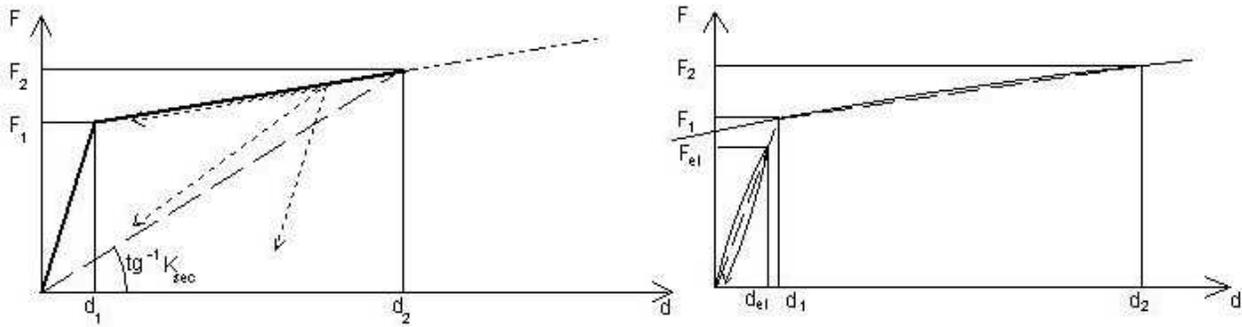
**Figura 11.9.1** – Diagrammi forza – spostamento per dispositivi non lineari
