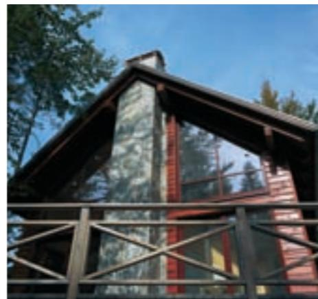
Entrambe i sistemi possono avere come rivestimento esterno la normale intonacatura fatta direttamente sul cappotto esterno, oppure in alternativa **la facciata ventilata** (rivestita in legno, pietra, metallo, laterizi, fibra di cemento o materiale artificiale), ancorata con viti sulla sottostruttura, che funge da intercapedine di ventilazione.
