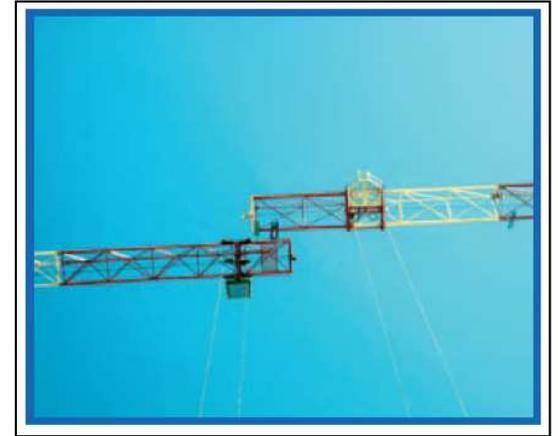
Per evitare interferenze di carichi (carico-carico, carico-fune ecc.) e di strutture (braccio-braccio, braccio controbraccio, braccio-torre ecc.):
