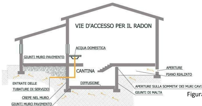
Figura 3: vie d'accesso per il radon
